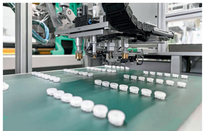
Bild 2. Mit der Turnkey-Anlage lassen sich die Nanotaster energieeffizient und flexibel fertigen. Das Robot-System Multilift V (rechts) legt die Fertigteile gerichtet auf einem Förderband ab. © Arburg
