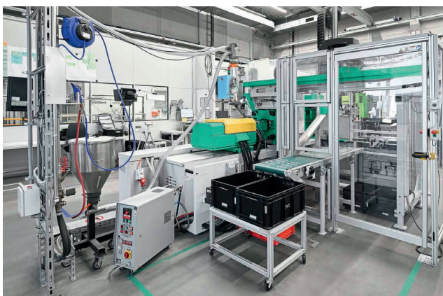
Bild 2. Mit der Turnkey-Anlage lassen sich die Nanotaster energieeffizient und flexibel fertigen. Das Robot-System Multilift V (rechts) legt die Fertigteile gerichtet auf einem Förderband ab. © Arburg
